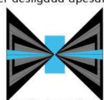
Deteção de movimento em, corredor
